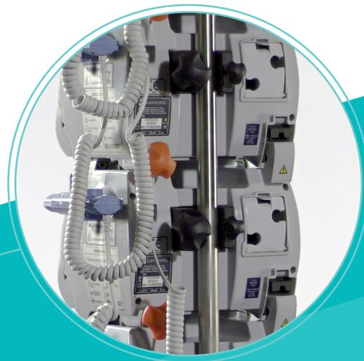
Possibilita o acoplamento e empilhamento de até **5 bombas icatu**, alimentadas por um único cabo.
